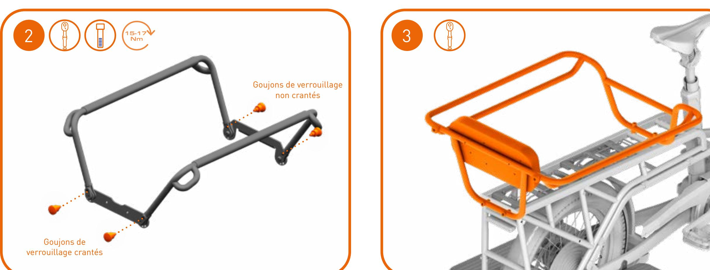
Installez les goujons de verrouillage crantés à l'arrière et les goujons de verrouillage non crantés à l'avant.
